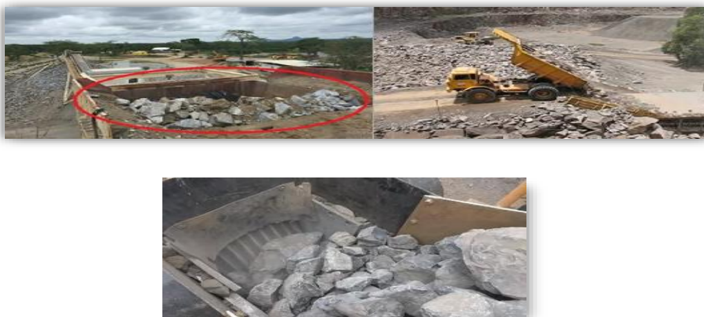
Figura 3.10 (a b e c): Descarga e fragmentação da rocha
