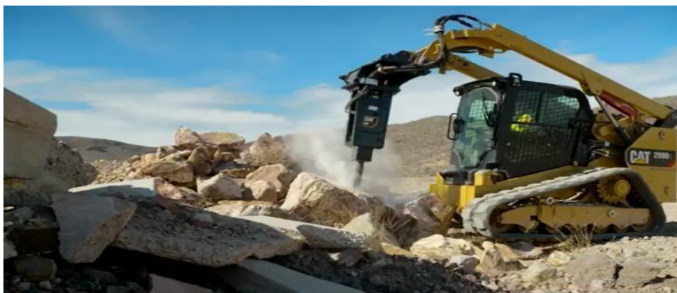
Figura 3. 7 : Martelos hidráulico usados na pedreira
